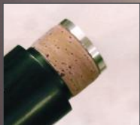
Emboîtement corps du haut / corps du bas avec serti métal
