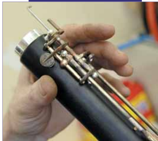
Sur ces espaces resserrés, la précision de montage doit être extrême afin que la partie mécanique soit à la fois fluide et précise sous les doigts du musicien.
