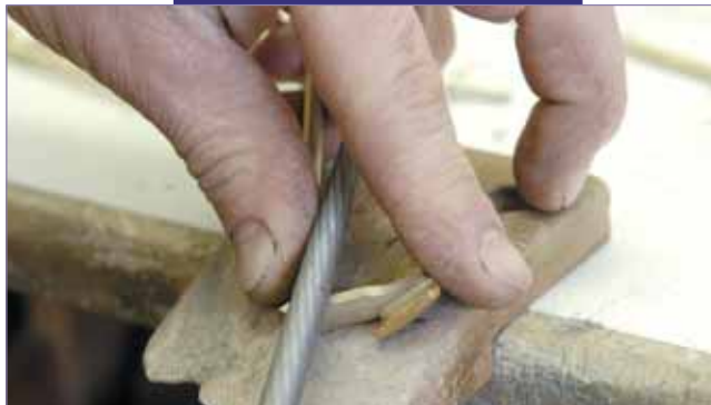
Pour ajuster précisément les pièces, la lime (avec des grains différents selon l'effet recherché) reste l'outil de base.
