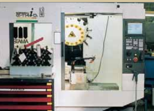
Machine à commandes numériques. Ce "centre d'usinage" réalise plusieurs opérations (lumière, creusage, plafond) avec une précision littéralement "surhumaine", inférieure au centième.
