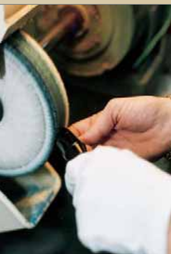
Les opérations de polissage demandent une grande maîtrise. Il s'agit de donner à l'ébonite un rendu parfaitement lisse, ce qui garantit le confort du musicien. Pour cette opération, on utilise une pâte à aviver et une brosse flanelle.
